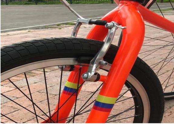
Los RaceRunners tienen frenos de llanta con zapatas de freno. Las zapatas se desgastan gradualmente y deben reemplazarse cuando sea necesario. Las zapatas de freno están disponibles en las tiendas de bicicletas regulares y son relativamente fáciles de reemplazar su precio varío según la marca y material. Tenga cuidado de ajustarlos correctamente para que se desgasten armoniosamente.
