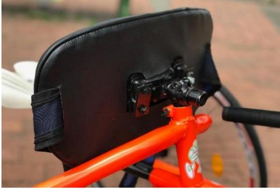
El bastidor, también denominado soporte corporal tiene como función soportar el peso del cuerpo en una inclinación frontal, genera máximo apoyo y estabilización de la zona abdominal, es adaptable según las condiciones del usuario.
