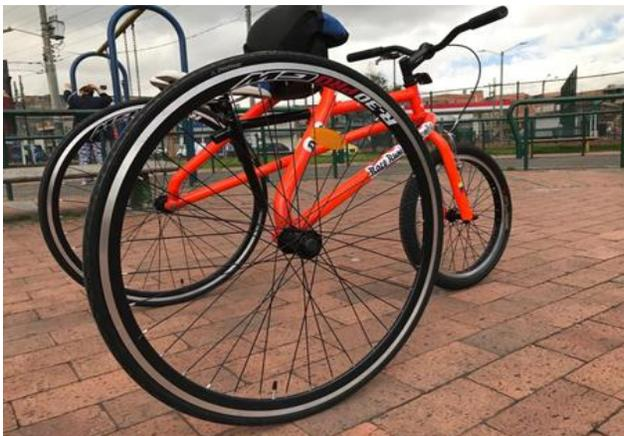
Las llantas traseras del RaceRunner poseen un rin 700 en la parte trasera, se desgastan gradualmente. Reemplace las llantas cuando la banda de rodamiento esté desgastada o si comienzan a aparecer grietas en los lados del neumático. Los neumáticos deben ser inflados de vez en cuando. Una presión de aire ligeramente reducida podría comprometer la comodidad y la velocidad del atleta.
